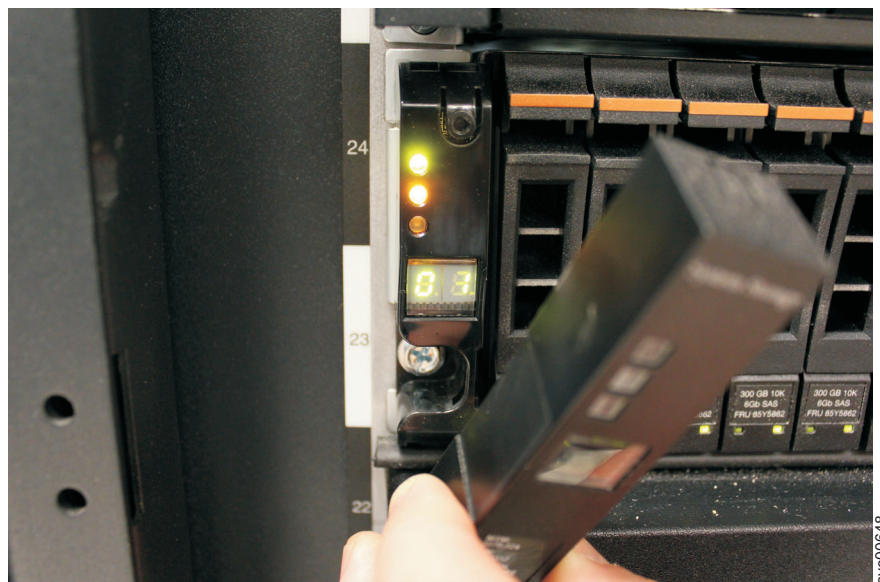
Figura 16. Removendo a Tampa da Extremidade do Gabinete
